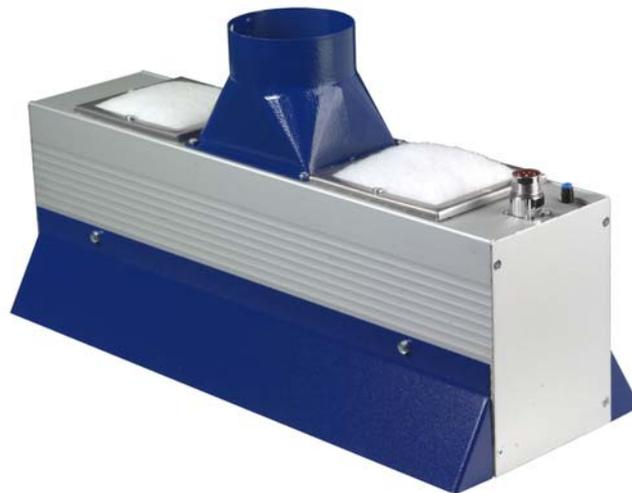
この装置は、空冷式で単一のランプを用いており、シルクスクリーン、フレキソ印刷で、連続的な印刷工程での UV インク、UV ニス、UV 接着剤およびコーティングを照射するために設計されました。この装置は、1つの UV ランプ (Hg (最大 120W/cm)) を装備しています。また、標準タイプでは、安定したアルミニウム・プロフィールハウジングを持っており、頑丈なアルミニウム半殻反射器、強力な外部アルミニウム吸込扇風機 (オゾンと熱の消耗)、アルミニウム制御入力および出力信号 (水晶板および漂遊磁界変圧器 (100%の UV ランプ出力)) を装備しています。電子安定器は有効に線間電圧変動を補います。また、UV ランプ出力は、30 から 100%まで連続的に調整可能です。
